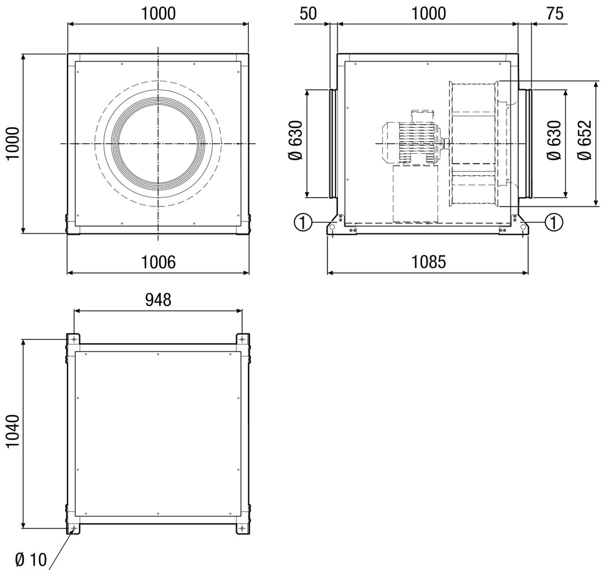
① Montagewinkel am Gerät montiert
