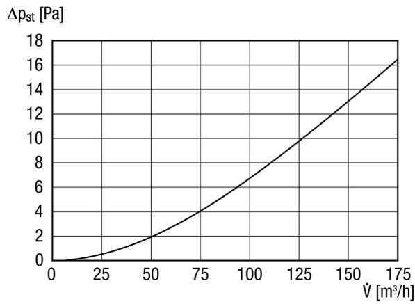
Die dargestellte Druck-Volumenstrom-Kennlinie gilt für das saubere Filtermedium. Abhängig von der Art und dem Umfang der Verschmutzung können bei unsauberem Filter höhere Druckverluste auftreten.
