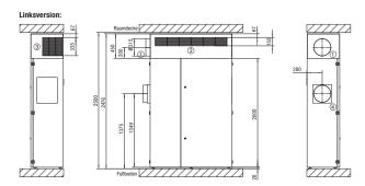
Topbox Standard für geniovent.x 600/900 S BL (Brüstungsvarianten mit seitlichem Außenluftanschluss nach links).
