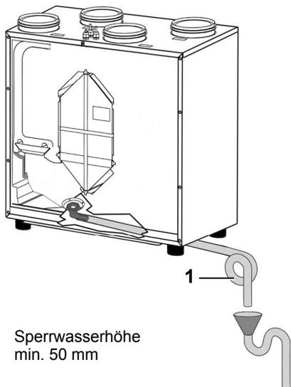
**ACHTUNG** Der Siphon (siehe Abbildung) benötigt eine Sperrwasserhöhe von min. 50 mm.
