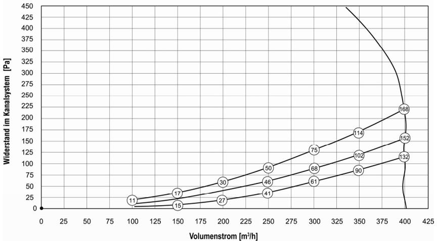
**i** Der im Kreis angegebene Wert ist die Leistung pro Ventilator (in Watt).
