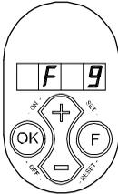
Das Gerät bleibt im Störungsmodus, bis das entsprechende Problem gelöst ist. Danach setzt sich das Gerät selbst zurück (Auto-reset), und die Anzeige kehrt wieder in den Betriebsmodus zurück.
