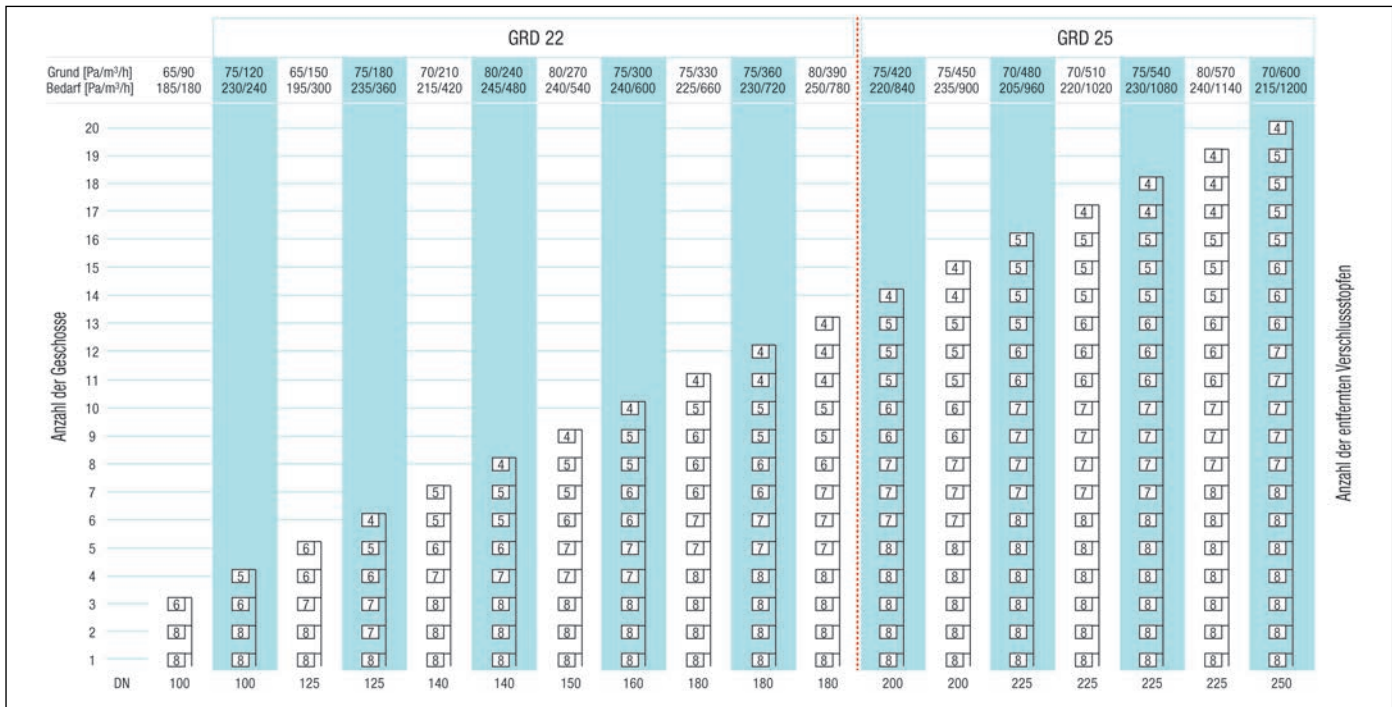
Diagramm 1: Auslegungs-Diagramm für Stränge mit einem Abluftelement je Geschoss
