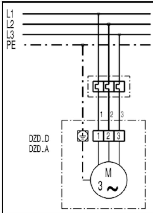
**DZD...D mit Verschlussklappe VE, RKP und Stellmotor MS 8, MS 8 P**
