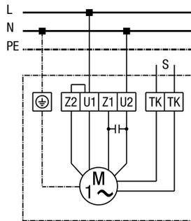
**Schallgedämmte Abluftbox EKR 40 mit Motorvollschutzschalter MVE 10 und 5-Stufentransformator TRE ...**
