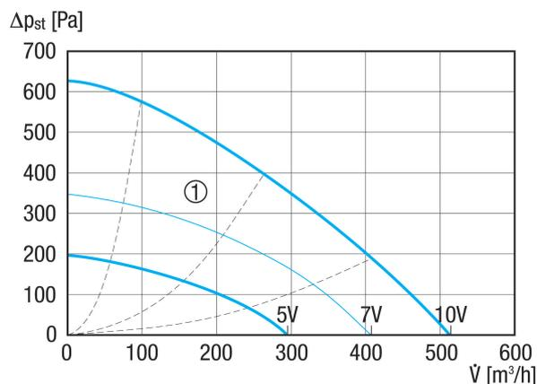
① Courbes caractéristiques auxiliaires de tension de commande de 5 V, 7 V et 10 V
