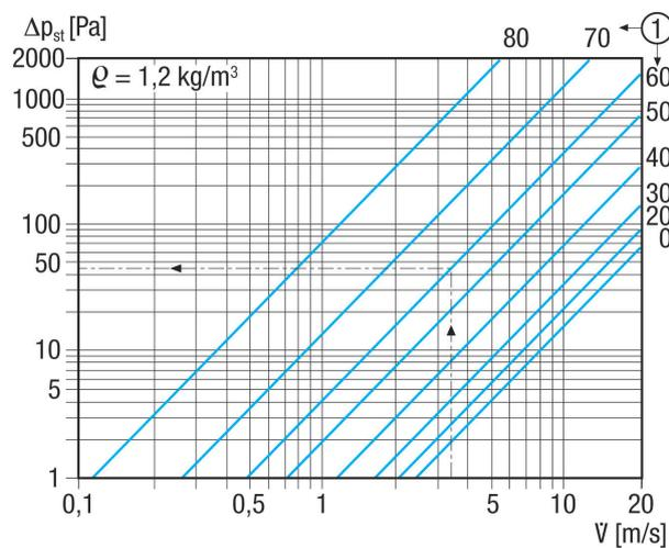
① Inclinaison des lamelles en degrés
