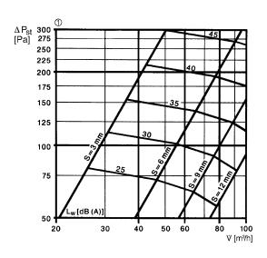
① Position du cône de la bouche, S = largeur de la fente
