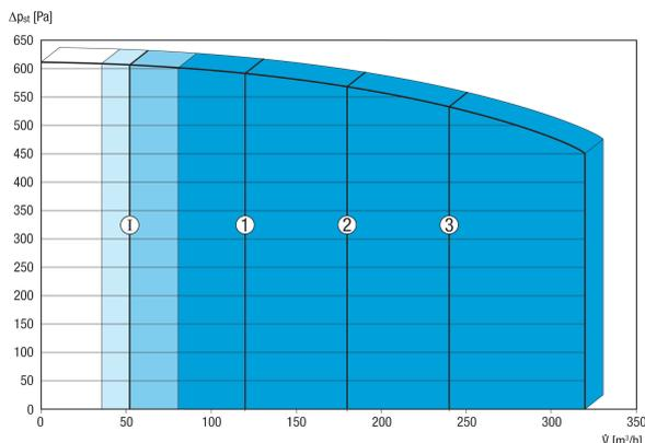
Les chiffres mentionnés indiquent les niveaux de ventilation pré-réglés (« réglages usine »).
