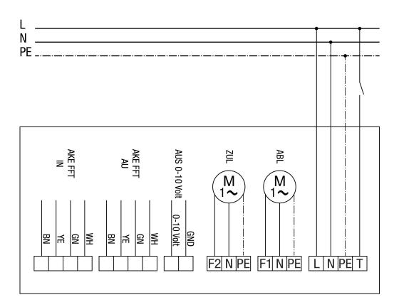
ABL air sortant ZUL air entrant AUS Sortie AU Extérieur IN Intérieur
