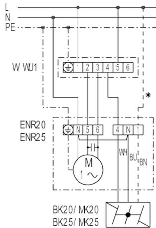
W 1 - Inverseur (évacuation / insufflation, Marche / Arrêt), apparent
