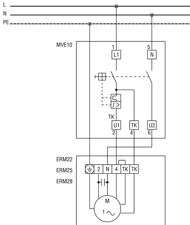
MVE 10 - Disjoncteur-protecteur moteur (à installer par le client)
