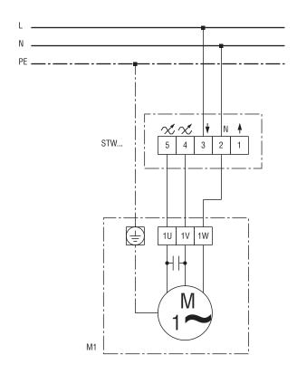
STW1 - Régulateur de vitesse Borne 1 - Branchement supplémentaire (sans régulation) M1 - ventilateur (rotation à droite/à gauche)
