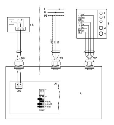
Raccord d'un hygrostat avec contact libre de potentiel. Si, en cas d'humidité ambiante, le contact libre de potentiel de l'hygrostat se ferme, alors l'appareil de ventilation passera au niveau LS3, quel que soit le niveau d'air réglé. Lorsque l'humidité ambiante est évacué (le contact de l'hygrostat s'ouvre), l'appareil de ventilation retourne au niveau d'air précédemment réglé.
