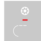
Fig. 1: Exemple de dysfonctionnement de l'unité de commande avec 3 éléments qui s'allument → dysfonctionnement / panne détecteur combiné CO2.
