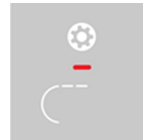
Abb. 1: Störungsbeispiel der Bedieneinheit mit 3 aufleuchtenden Elementen → Störung/Ausfall Kombisensor CO 2 .
