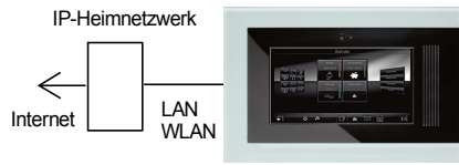
KNX Facility Panel mit Internetzugang
