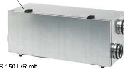
Maico Zentrallüftungsgerät WS 150 L/R mit 90% Wärmerückgewinnung für Wohnungen, Einfamilienhäuser und Gewerbe
