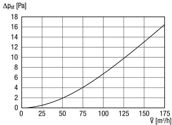
Приведенная кривая давления и объемного расхода действительна для чистой фильтрующей среды. В зависимости от характера и объема загрязнения загрязненный фильтр может вызывать значительные потери давления.
