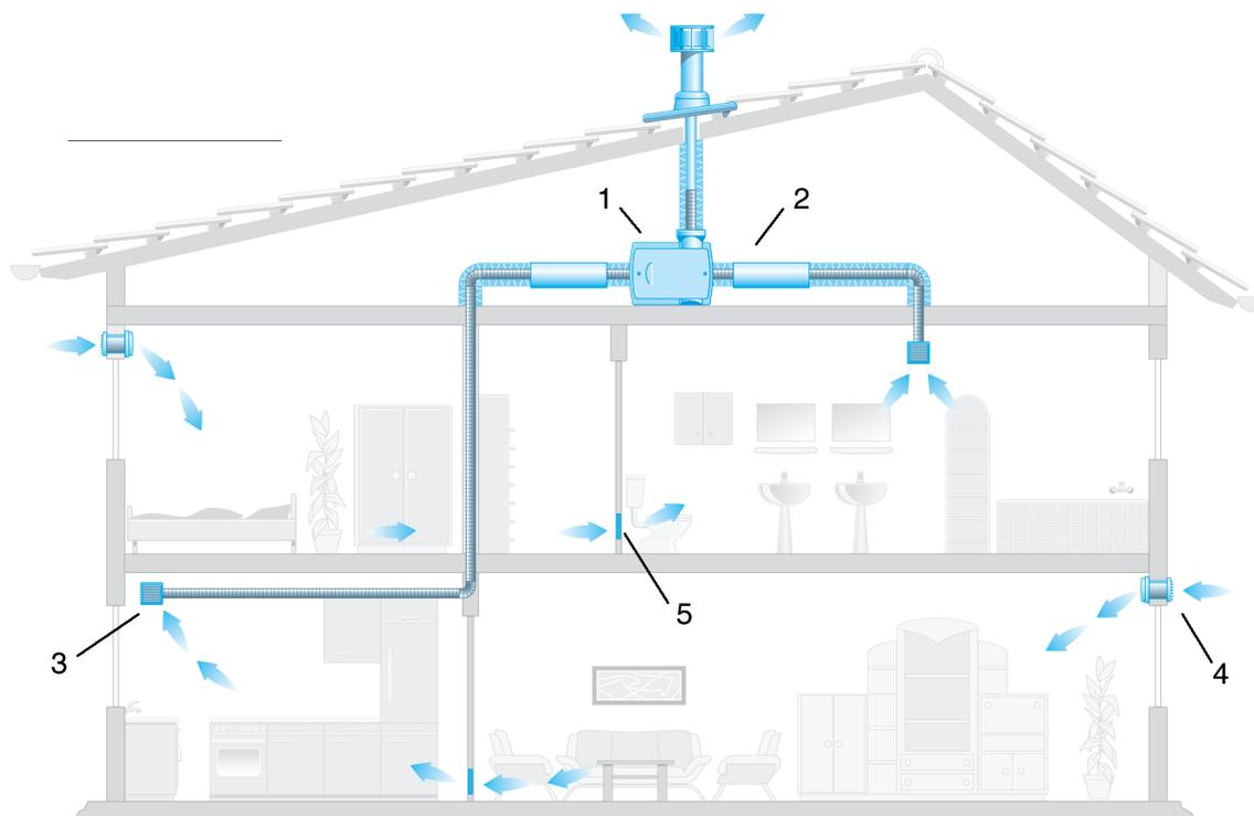
1 прибор вытяжной вентиляции ZEG
