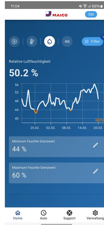
Unter **Home** wird die in der Abluft gemessene Luftfeuchte und deren Verlauf angezeigt.
