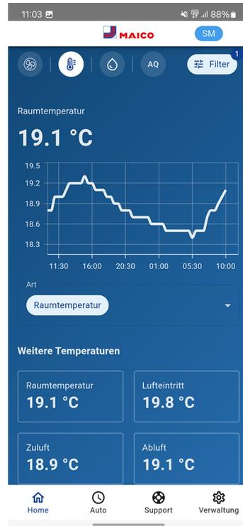
Unter **Home** sehen Sie die für das Lüftungssystem wesentlichen Temperaturen der Wohnräume. Das Diagramm zeigt den Temperaturverlauf im gewählten Zeitabschnitt für den angegebenen Wohnraum. Im Feld **Weitere Temperaturen** sehen Sie die von den Temperatursensoren ermittelten Temperaturwerte.
