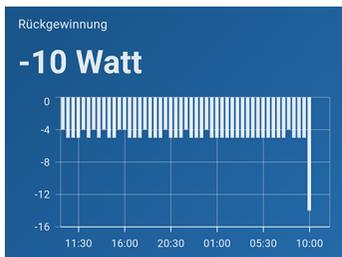
Bei Minus-Angaben wird dem Lüftungsgerät Energie zugeführt.
