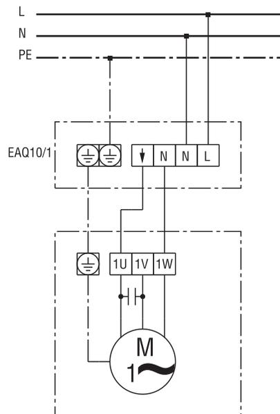
M1 - Вентилятор (вращение против часовой стрелки)
