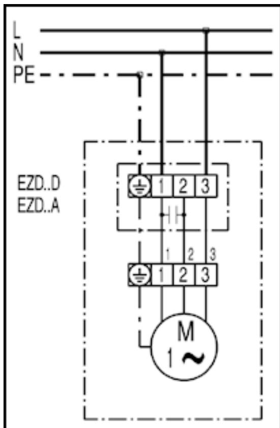
Вращение по часовой стрелке: EZD...D с выбросом воздуха со стороны двигателя
