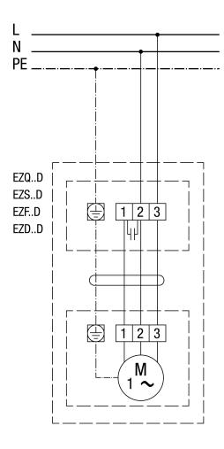
Вращение по часовой стрелке: EZD 25/4 D со всасыванием воздуха со стороны двигателя
