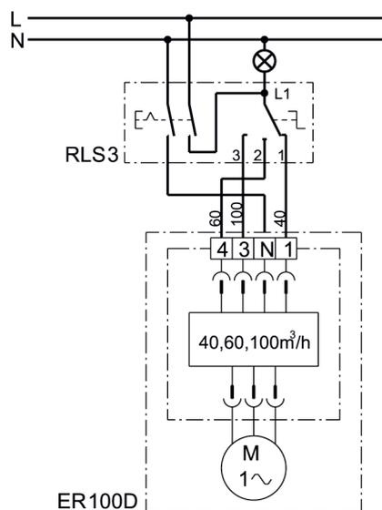
RLS 3 - Вентиляционный контроллер с нулевой позицией и выключателем для освещения помещения
