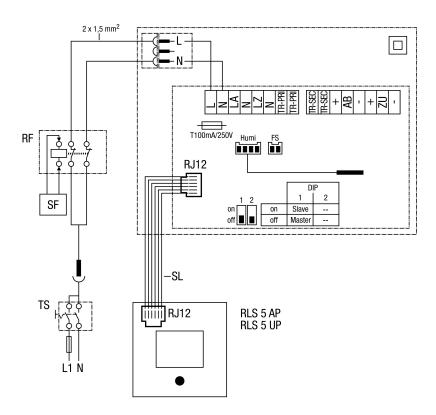
RF - при наличии каминов, зависимых от воздуха в помещении, обеспечивается заказчиком
