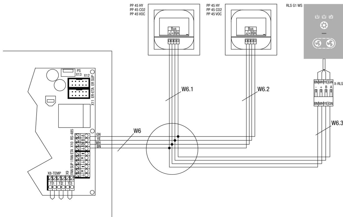
W6 - присоединительный провод внешний компонент. Рекомендуемая модель провода LIYCY 4x0,34мм<sup>2</sup>. У приборов с подключением внешней панели управления экран кабеля должен быть подключен к панели электроники.
