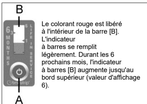
Le colorant rouge est libéré à l'intérieur de la barre [B]. L'indicateur à barres se remplit légèrement. Durant les 6 prochains mois, l'indicateur à barres [B] augmente jusqu'au bord supérieur (valeur d'affichage 6).
